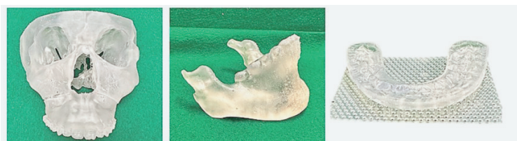
3D プリンターを用いた顎骨模型・サージカルガイドの製作
